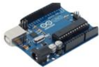
Carte Arduino Uno (interface programmable)
